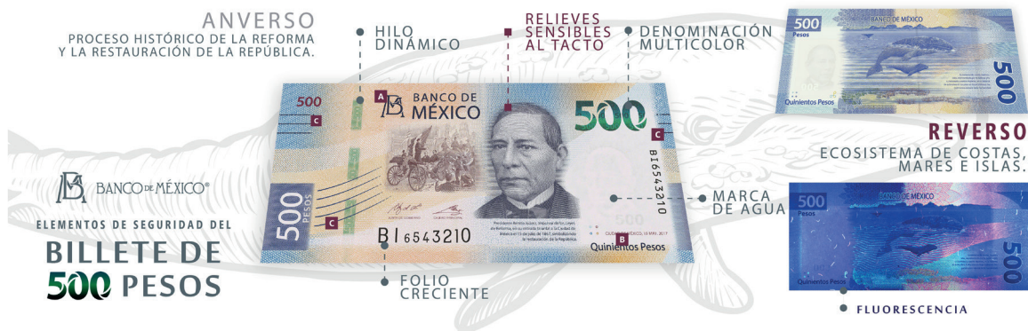
Elementos de seguridad del billete de 500 pesos de la "familia G"
